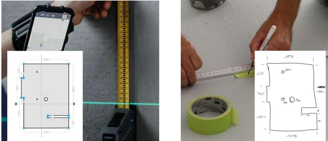
Das patentierte, digitale Aufmaß-System von Solaflex vereinfacht den Messprozess durch zuverlässige Datenerfassung. Traditionelle Handzettel werden abgelöst, indem Messdaten direkt digital erfasst und verarbeitet werden. Ein effizienter Ansatz der Zeit spart und Fehler minimiert.
